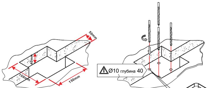
Зафиксируйте основу (инсталляцию) с помощью анкерных болтов
