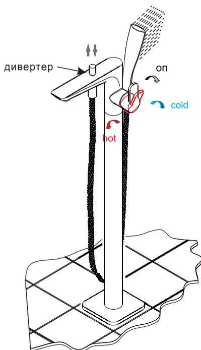
Переключение между наливом воды и ручным душем с помощью дивертера
