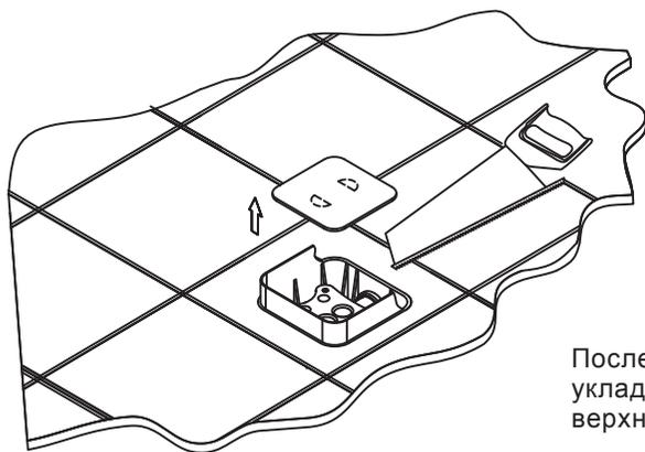
После окончания работ по укладке плитки, срежьте верхнюю часть инсталляции
