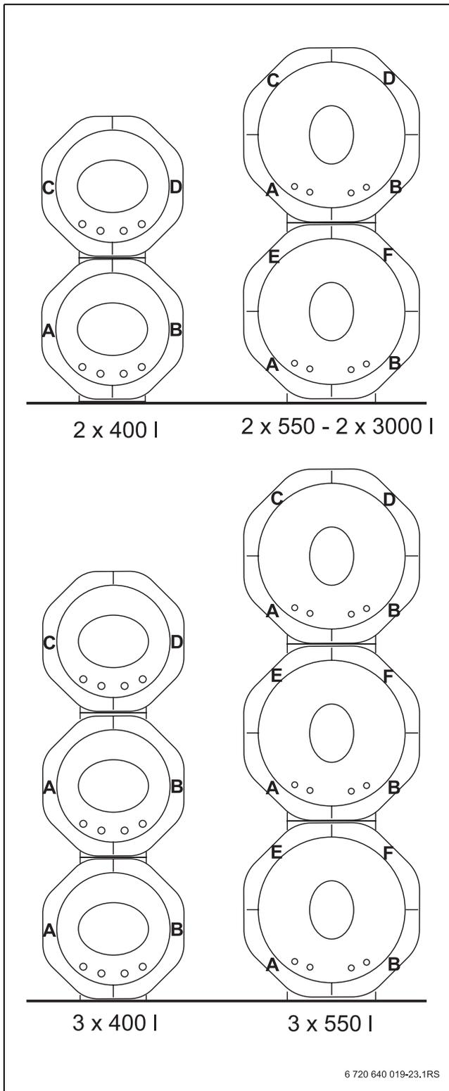
Рис. 26 Маркировка теплоизоляционных сегментов двойных и тройных баков
