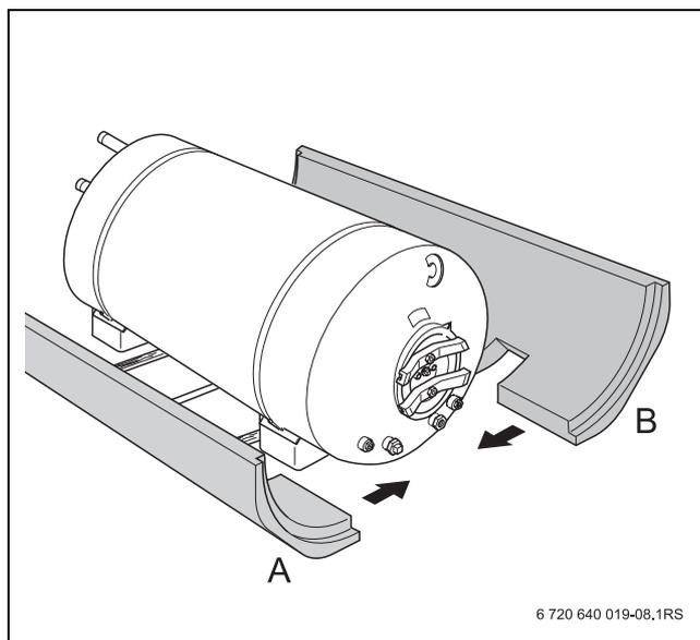
Рис. 10 Монтаж теплоизоляционных сегментов А и В
