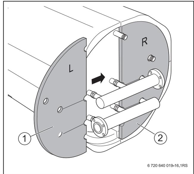
Рис. 19 Монтаж теплоизоляционных сегментов задней стенки
