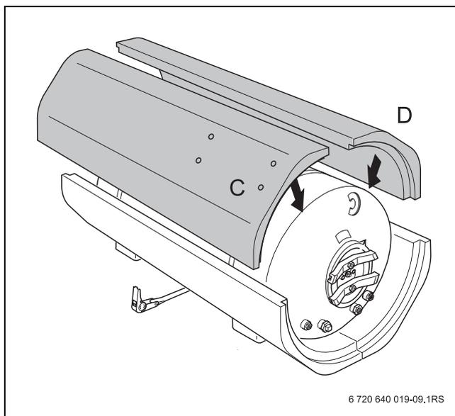
Рис. 11 Монтаж теплоизоляционных сегментов С и D
