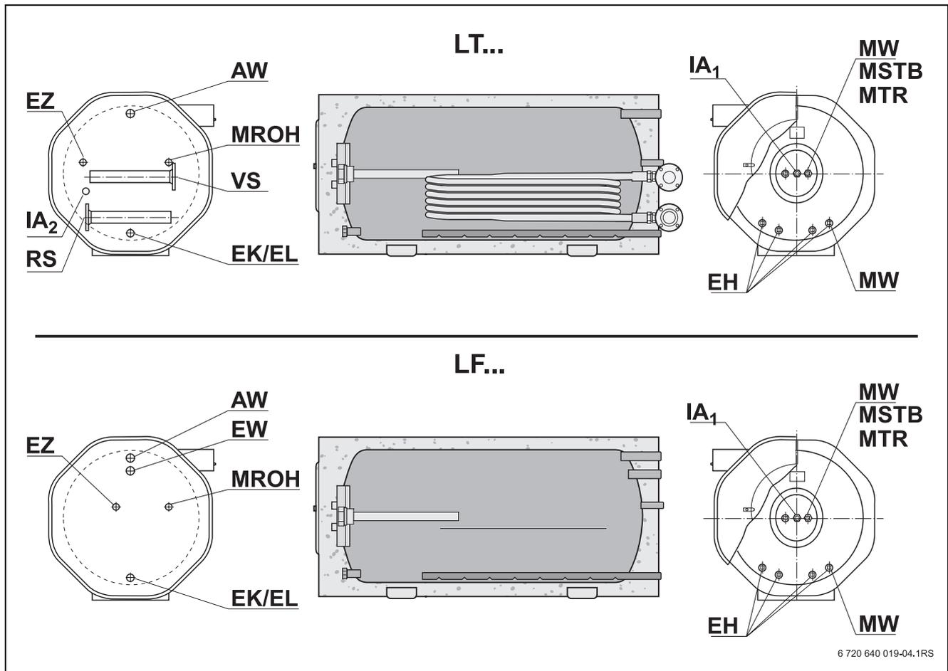
Рис. 1 Подключения LT/LF
